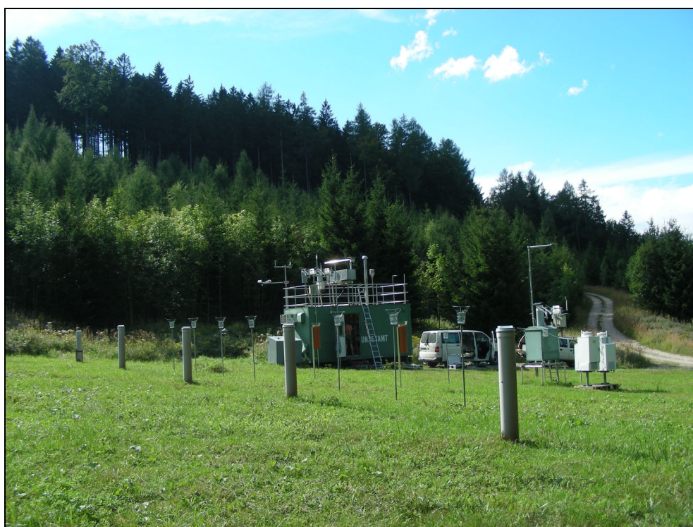
Abbildung 9: Messstelle Zöbelboden (Wildwiese) von Osten. Im Vordergrund stehen Niederschlags- und Staubbiederschlagssammler, rechts WADOS. (© Umweltbundesamt, Rokop)
